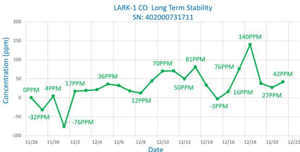
从上图我们可以看出，LARK-1 CO 在温度、湿度不受任何控制的条件下，零点基本上保持稳定，1 个月的漂移在-100ppm — 150ppm 之间。当然，在我们测量的过程中是加了一个气泵(500ml/min)和一个 20um 的灰尘过滤器的。
