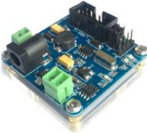
诺联芯在今年3月发布了一款基于RS485的LARK-1 Modbus通讯转换器，型号为“MODBUS COMM-CONVERTER”，订货号是“001-3010-000”。该转换器的作用是：将LARK-1系列传感器基于文本形式的通讯协议转换为工业中广泛应用的Modbus RTU协议。那么该转换器有什么特色呢？它又可以用到一些什么场合中去呢？
